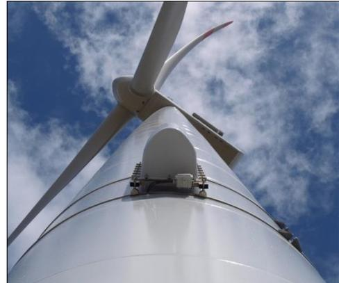
Ilustración 5: Sensores MSPSR adheridos magnéticamente
