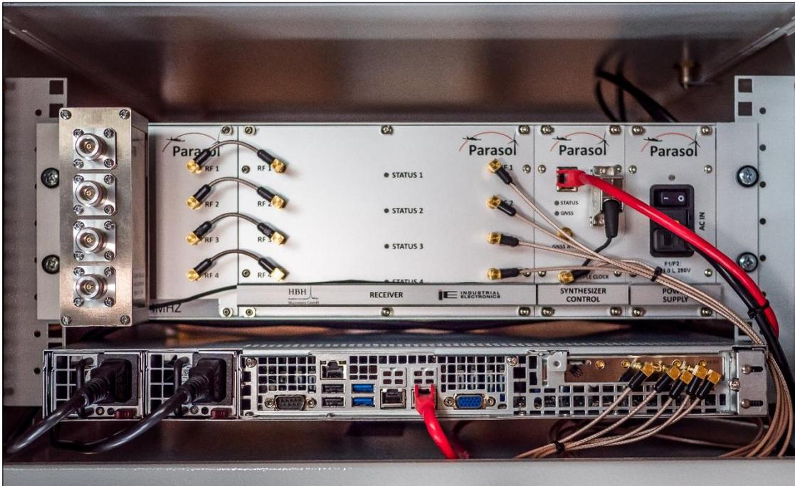
Ilustración 6: Módulo de procesamiento PRS
